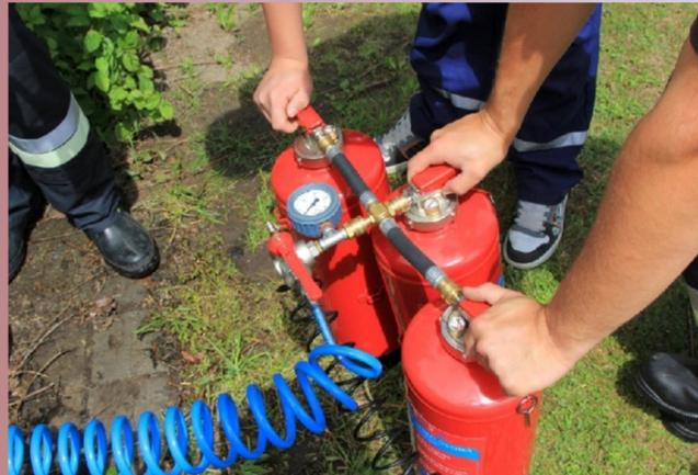
*Das Befüllen von drei Übungslöschern gleichzeitig*
